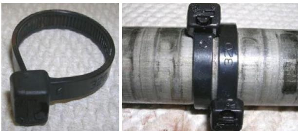
写真上 24時間後のナイロン66、写真下は3288時間後の耐候性ポリプロピレン
