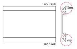
FCシリーズなどのフレームに加工の場合、はめ込み側とネジ 止め側で上下の向きが異なります。必ず上下の向きをご指示 下さい。
