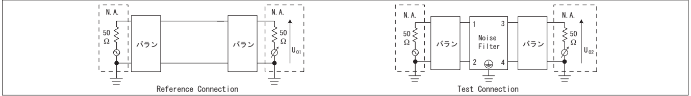
図 3.1 ノーマルモード減衰特性測定回路
