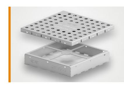
TE Connectivity (TE) の標準ボードレベルシールド (BLS) 製品は、アプリケーションでのクロストークを最小化するとともに、EMI対策としてのソリューションです。 また、標準品を準備していますので、市場投入までの時間を短縮することができます。BLSには、冷間圧延鋼 (CRS) 材料に加えて、重さが1/3のアルミニウムタイプがあります。アルミニウムタイプは、同等のEMI対策機能を備えながら、大幅な軽量化を実現するとともに、CRS材料よりも最大5倍の熱伝導率を実現しており、デバイスやシステムに使用されているシールドコンポーネントの放熱対策にもお役立ていただけます。
